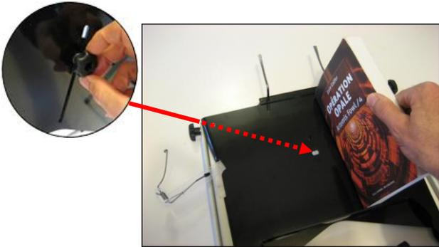
1. Desserrer la molette centrale à l'arrière et régler la hauteur du pupitre en présentant le livre qui doit reposer sur la régllette du bas et remonter juste sous les deux "Serre-livres".
