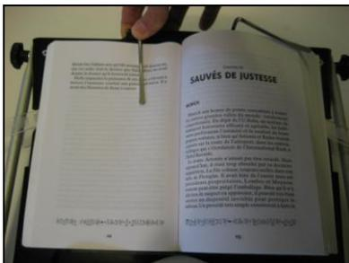
3. Ouvrir le livre à l'endroit où l'on souhaite démarrer la lecture et le présenter bien centré sous les deux Serre-livres. Du côté gauche, presser le Serre-livre qui doit écraser la partie la plus rebondie des pages, à quelques centimètres du centre.
