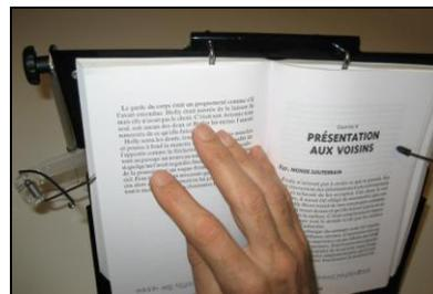
2. Tourner la page et la plaquer par-dessus l'embout en caoutchouc de gauche.
