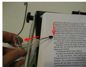
8. Affiner enfin le réglage des Barres latérales en les retirant cran par cran jusqu'à amener l'embout en caoutchouc de la Tige-ressort en bordure du texte.
